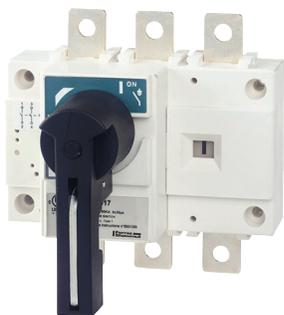
Le sectionneur de surtension est un sectionneur extrêmement compact, de haute performance, à commande manuelle, sans fusible. Spécialement conçu pour résister à un courant de choc de 200 kA sous une forme d'onde de 8x20  $\mu$ s pour les dispositifs de protection contre les surtensions transitoires (DPS) actuels. Le sectionneur de surtension de Mersen utilise une conception unique permettant de serrer les contacts plus fermement pendant une surtension.
