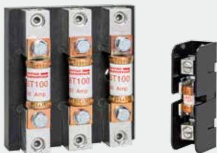
Les porte-fusibles de Classe T de Mersen sont conçus pour tous les fusibles de Classe T jusqu'à 600V. Les isolateurs sont fabriqués de polycarbonate renforcé de fibre de verre (GPFC) ou en phénolique avec une rigidité diélectrique supérieure à 2500V. Mersen est le seul fabricant à offrir des porte-fusibles avec des connecteurs en cuivre.
